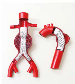
実物大に近い模型で、ステントグラフト(人工血管)を使う動脈瘤の治療を説明します。
